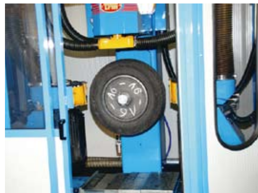
An zwei vollautomatisch arbeitenden Raumaschinen werden die Karkassen geraut.
